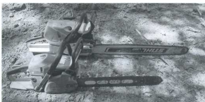
※写真上が金折班員のチェーンソー 排気量：72.2cc 重量：約6.5kg バーの長さ：63cm (スチール社製MS462)
