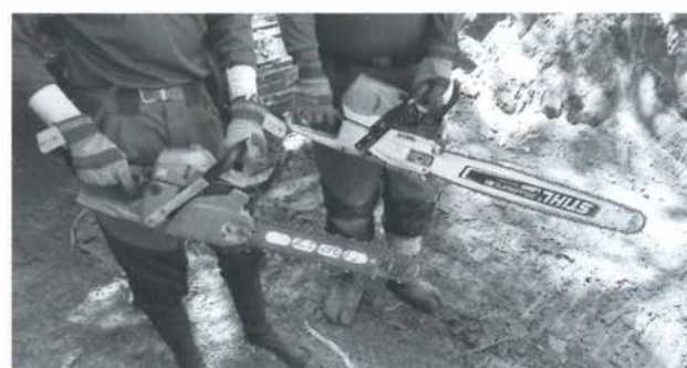
写真下は山で使用する一般的なチェーンソー 排気量：35.0cc 重量：約3.8kg 長さ：35cm
